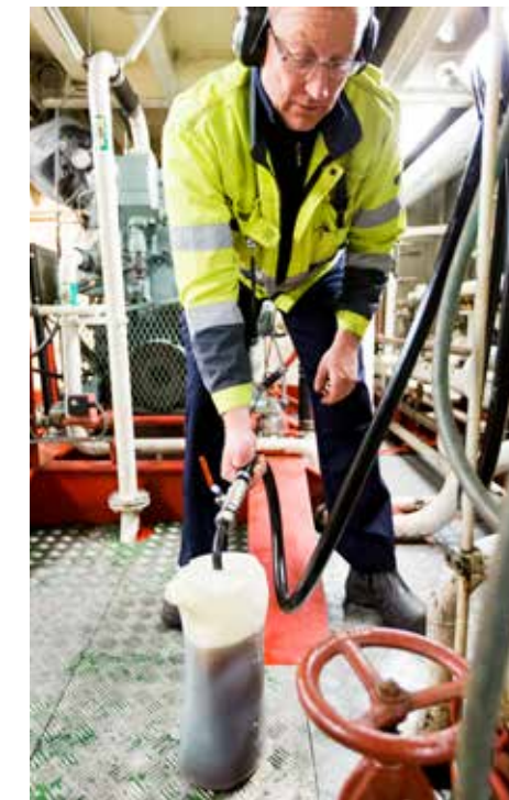
Oljebyte på Gräsöleden. Motorman/matros Håkan Brus visade upp hur denna rutinåtgärd genomförs i maskin. Bilden är från 2013. Foto: Kasper Dudzik
