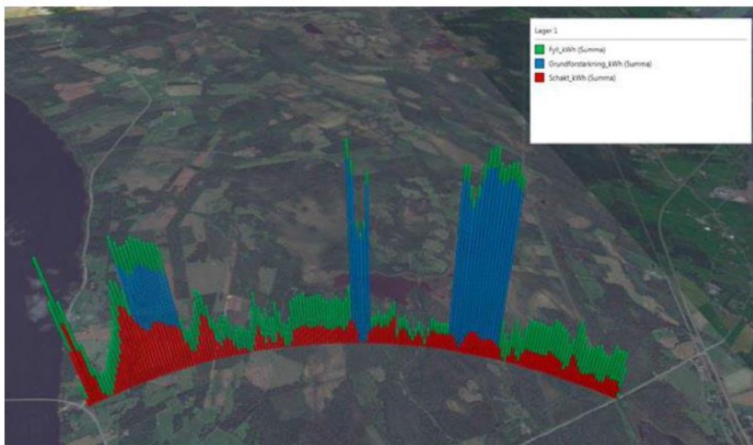
Figur 1 Illustrativ bild över beräknad mängd schakt, grundförstärkning och fyll summeras i enheterna SEK, CO2e eller kWh.
