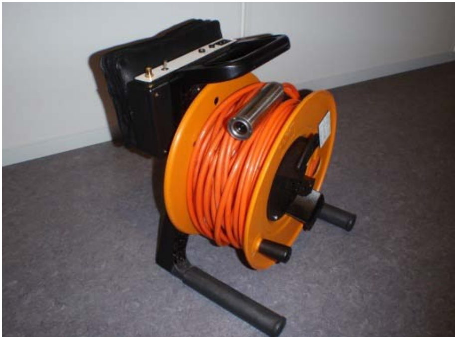
Figur 4. Undervattensvideokamera, Inspecam L, KT28, med kabel och DVR. (Foto Ann Bertilsson).
