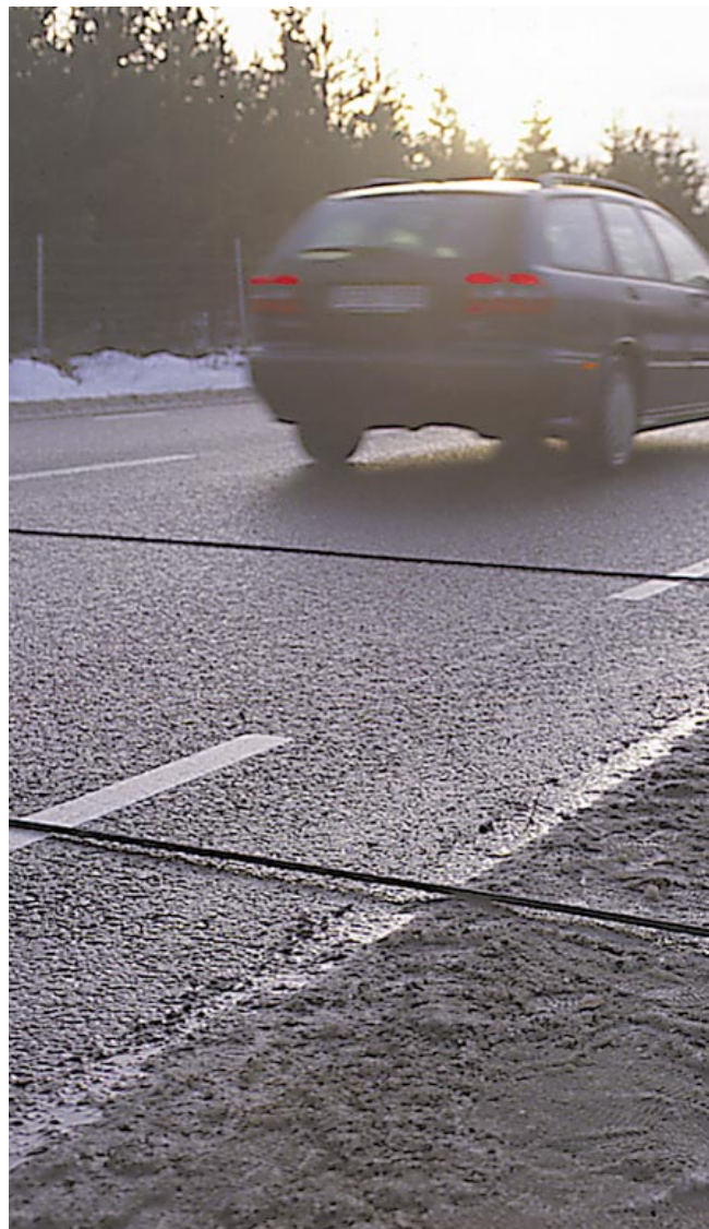
Varje dag mäts trafikarbetet, hastigheter, avstånd mellan fordon och fordonstyp på ca 250 platser på vägnätet i den här typen av "mätstationer".
