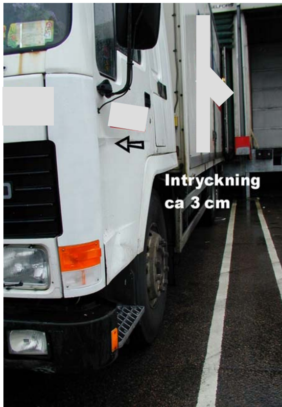
Figur 3 Skador på lastbilen.
