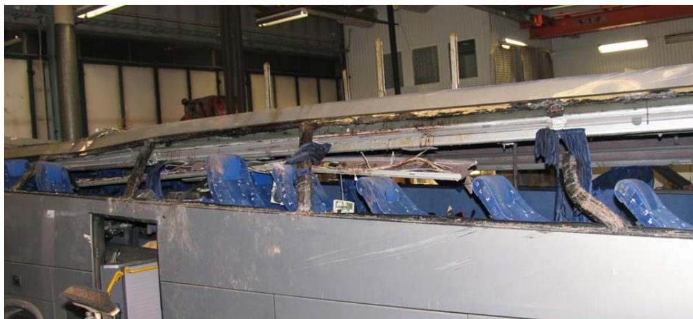
Figur 2.4: Bilden visar att det finns få skrapmärken på bussens sida
