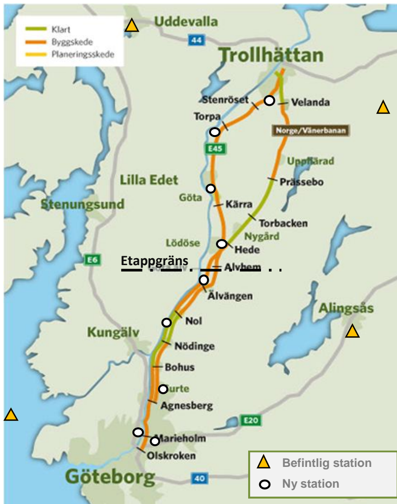
Figur 1, förtätningen av SWEPOS för PA-NRTK gjordes med 9 nya referensstationer i två etapper, Marieholm-Älvängen, och Älvängen-Trollhättan. De gula trianglarna visar befintliga SWEPOS stationer vid etableringstillfället. Idag finns det betydligt fler i området kring Göteborg.
