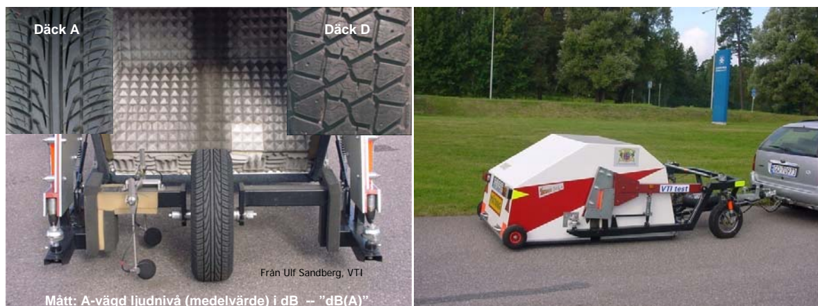
Figur 1 Utrustning för mätning av buller enligt CPX-metoden (Ulf Sandberg, VTI)
