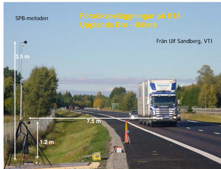
Figur 2 Utrustning för mätning av trafikbuller med SPB-metoden (Ulf Sandberg, VTI).
